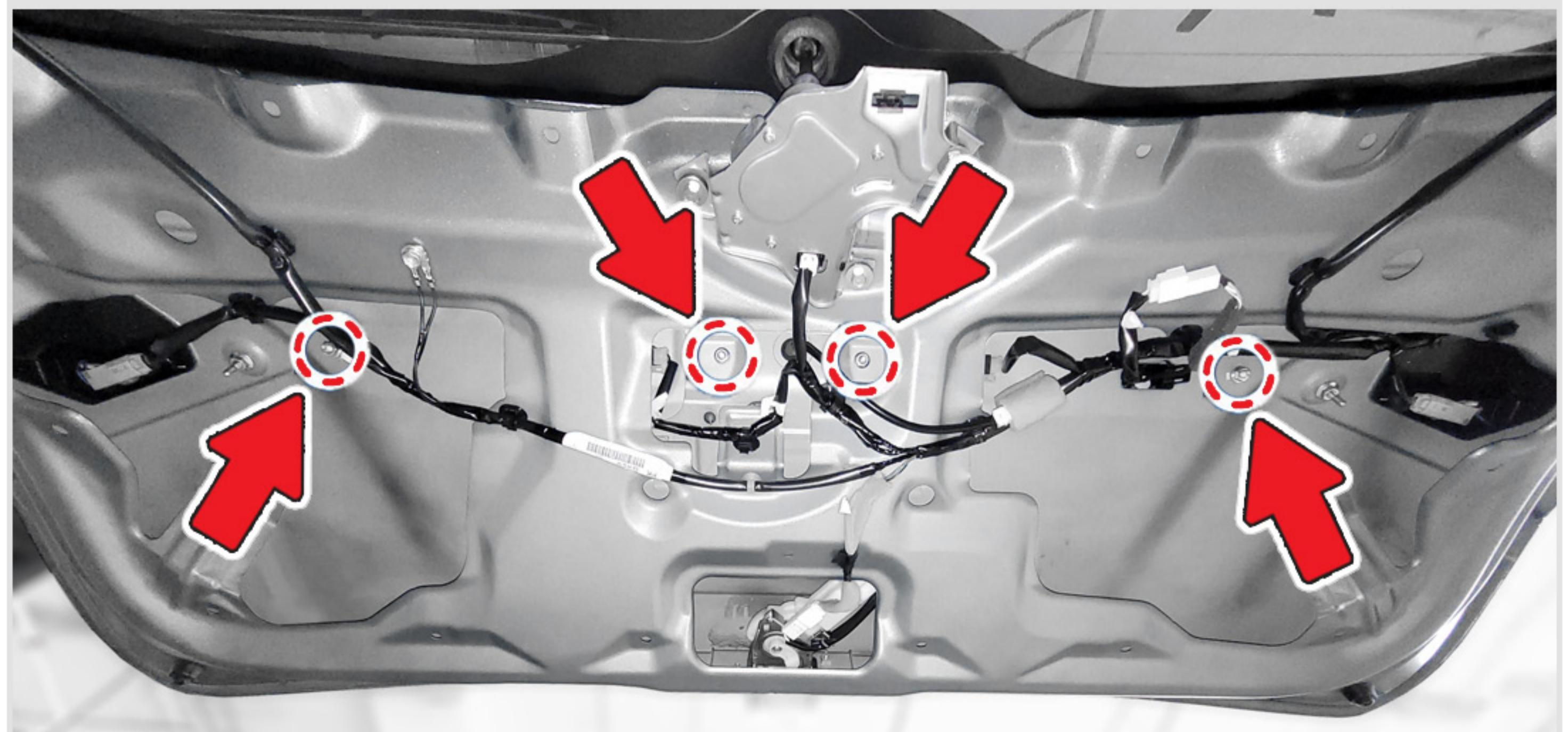
4 Освободите **3 клипсы** и снимите **наружную накладку** крышки багажного отделения.
