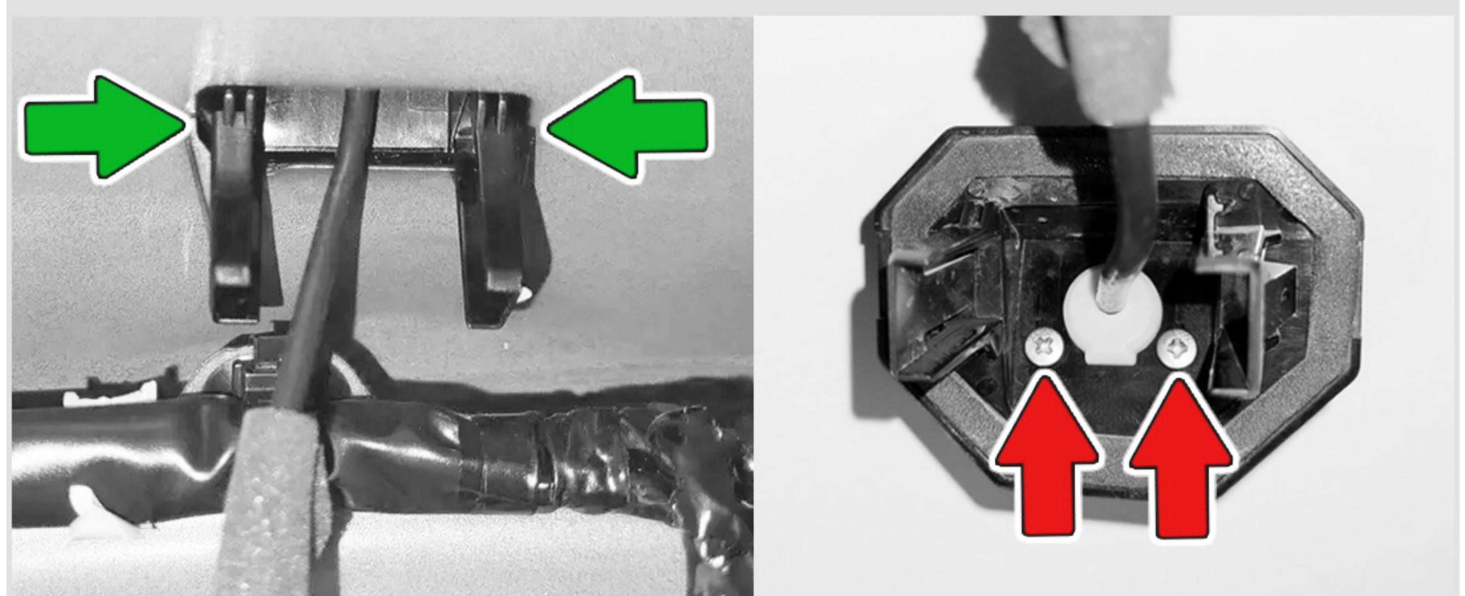
6 Разберите разъем проводки камеры. С помощью острого предмета освободите **боковой фиксатор**, затем освободите **фиксаторы каждого пина** и выньте их из разъема. Снимите камеру с кронштейна.
