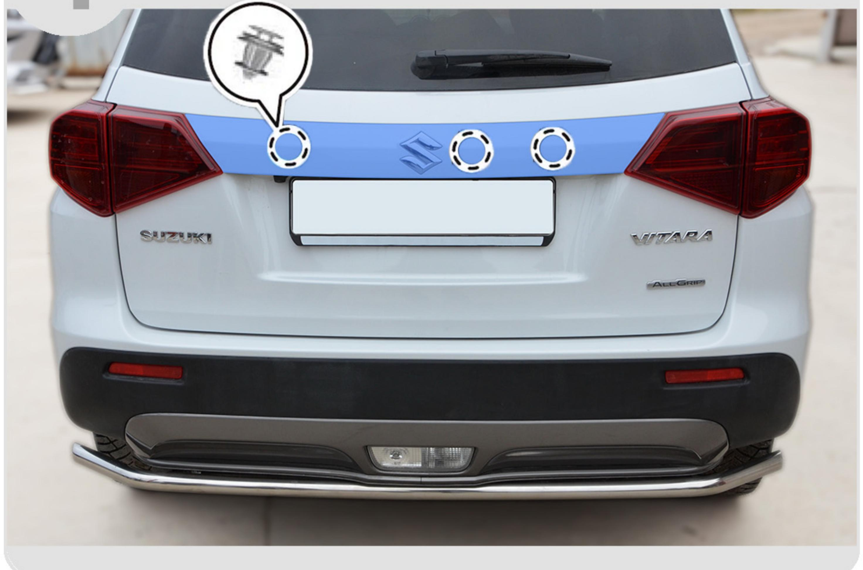
5 Сожмите **клипсы** и снимите кронштейн с камерой заднего вида. Отверткой PH1 отверните **винты** крепления камеры к кронштейну.
